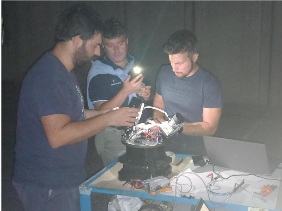
Figura 11 Regolazione inclinazione asse ottico telecamere
